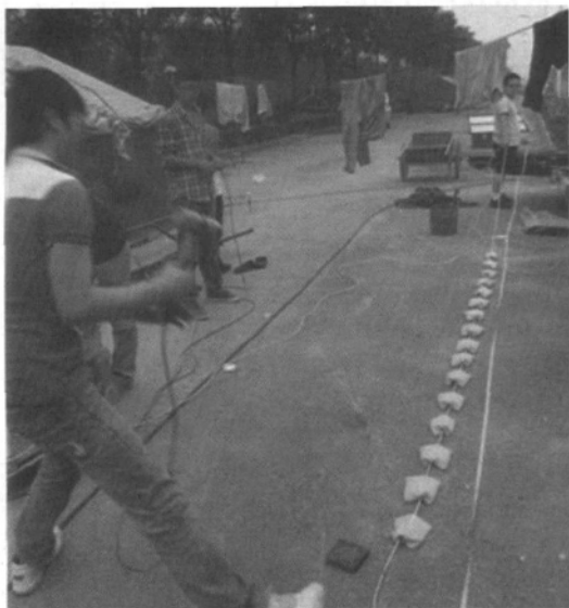
图4 RDscan 拖地耦和检波器串工作模式
