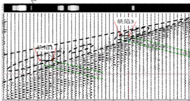
图 2.2 波纹管缺陷声波散射追踪偏移图像
